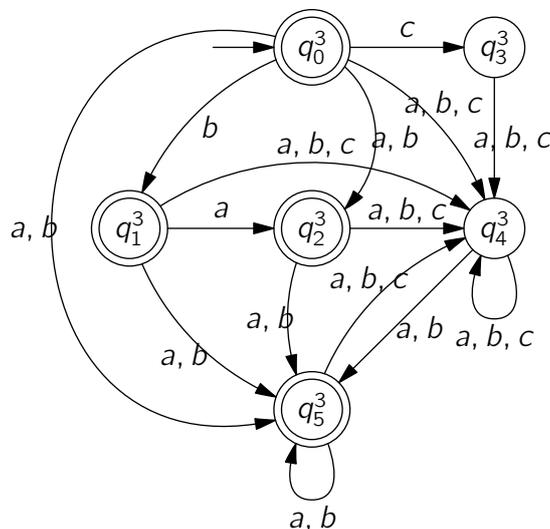
Nach Anwendung der Potenzmengenkonstruktion erhalten wir den folgenden DFA  $M_3''$ .
