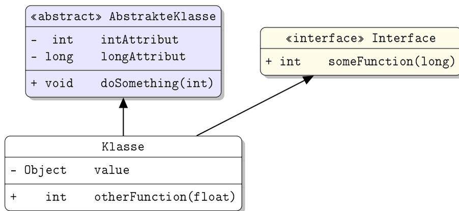
Eine Klasse wird hier durch einen Kasten beschrieben, in dem der Name der Klasse sowie Attribute und Methoden in einzelnen Abschnitten beschrieben werden. Weiterhin bedeutet der Pfeil  $B \rightarrow A$ , dass  $A$  die Oberklasse von  $B$  ist (also `class B extends A` bzw. `class B implements A`, falls  $A$  ein Interface ist). Benutzen sie - um `private` abzukürzen und + für alle anderen Sichtbarkeiten (wie z.B. `public`).
