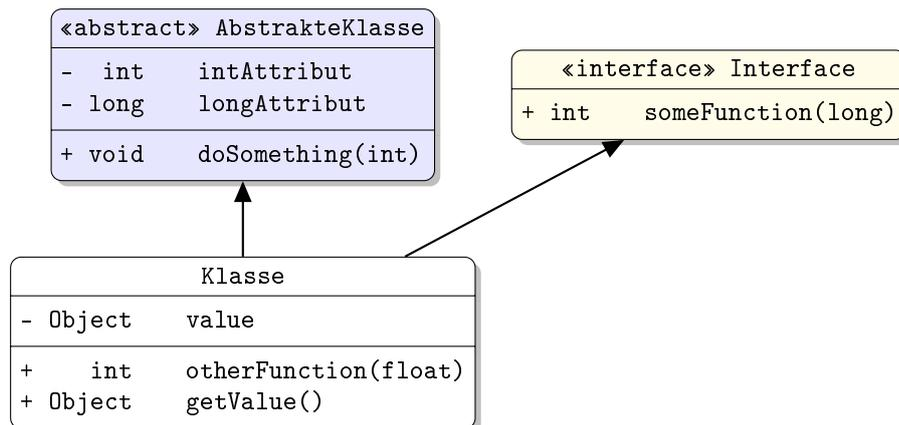
Eine Klasse wird hier durch einen Kasten beschrieben, in dem der Name der Klasse sowie Attribute und Methoden in einzelnen Abschnitten beschrieben werden. Weiterhin bedeutet der Pfeil  $B \rightarrow A$ , dass  $A$  die Oberklasse von  $B$  ist (also **class B extends A** bzw. **class B implements A**, falls  $A$  ein Interface ist). Benutzen Sie -, um **private** abzukürzen, und + für alle anderen Sichtbarkeiten (wie z. B. **public**).
