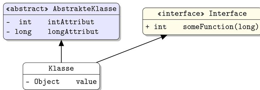
Eine Klasse wird hier durch einen Kasten beschrieben, in dem der Name der Klasse sowie Attribute und Methoden in einzelnen Abschnitten beschrieben werden. Weiterhin bedeutet der Pfeil  $B \rightarrow A$ , dass  $A$  die Oberklasse von  $B$  ist (also `class B extends A` bzw. `class B implements A`, falls  $A$  ein Interface ist). Benutzen Sie `-`, um `private` abzukürzen, und `+` für alle anderen Sichtbarkeiten (wie z. B. `public`).
