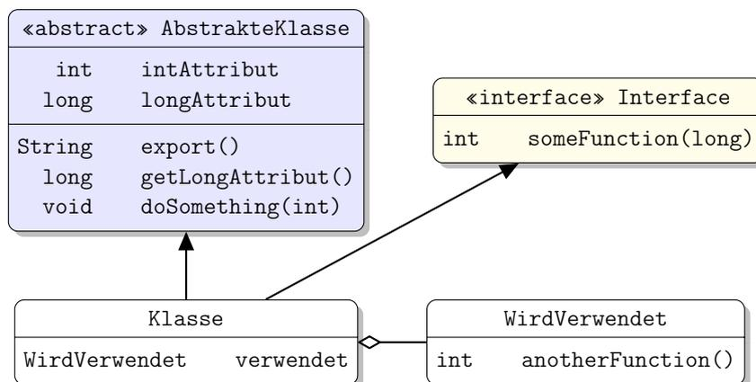
Eine Klasse wird hier durch einen Kasten beschrieben, in dem der Name der Klasse sowie Felder und Methoden in einzelnen Abschnitten beschrieben werden. Weiterhin bedeutet der Pfeil  $B \rightarrow A$ , dass  $A$  die Oberklasse von  $B$  ist (also `class B extends A` bzw. `class B implements A`, falls  $A$  ein Interface ist) und  $A \diamond B$ , dass  $A$  den Typ  $B$  verwendet (z.B. als Typ eines Feldes oder in einem Array).
